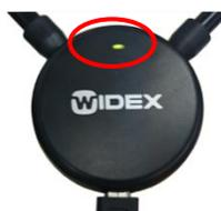
※ 正しくドライバーが適用されると、Widex USB Link の緑のランプが点滅します。
